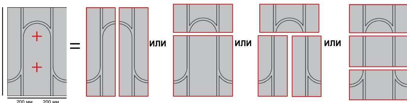
Для начала укладки системы способом «Змейка» (стр. 5) необходимо разрезать пластину пополам вдоль длинного края. Для этого берем пластину, прикладываем линейку, и, ориентируясь на насечки осуществляляем резку. Не пытайтесь разрезать элемент за один проход ножа в глубину. Лучше резать в 2-3 приема.
