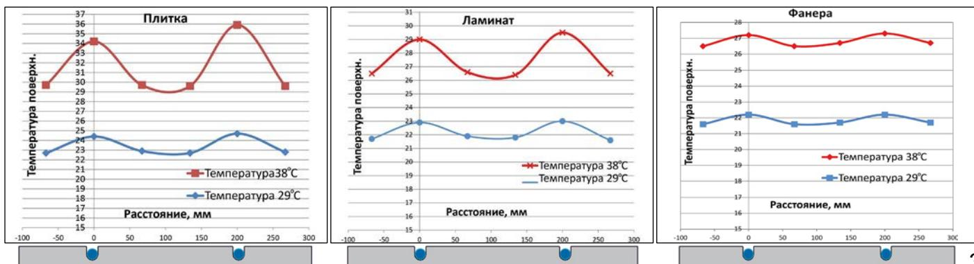
Наблюдается повышенный температурный градиент на полу с плиткой при высоких температурах и больших отопительных нагрузках из-за того, что плиточный клей становится теплопроводящим включением в «пирамиде» теплого пола, впрямую передавая тепло от трубы к плитке.
