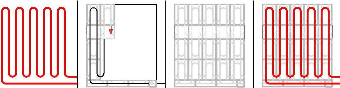
Начинать укладку элементов «Змейкой» рекомендуется от места «входа» контура с помощью пластин, разрезанных пополам вдоль длинного края. Как только уложенные элементы достигнут угла с дальней стеной помещения, вдоль нее укладываются целые элементы системы. Затем пластины заполняются вся площадь помещения в соответствии с чертежом. Разворачивать пластины при этом не нужно.
