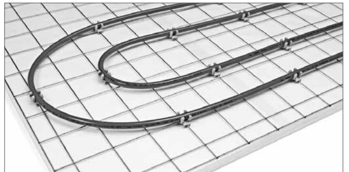
Рис. 21-20 Система крепления труб на арматурной сетке
