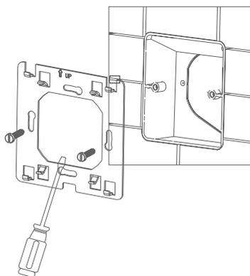
4) Присоедините к задней панели корпус терморегулятора, затем верхнюю панель.
